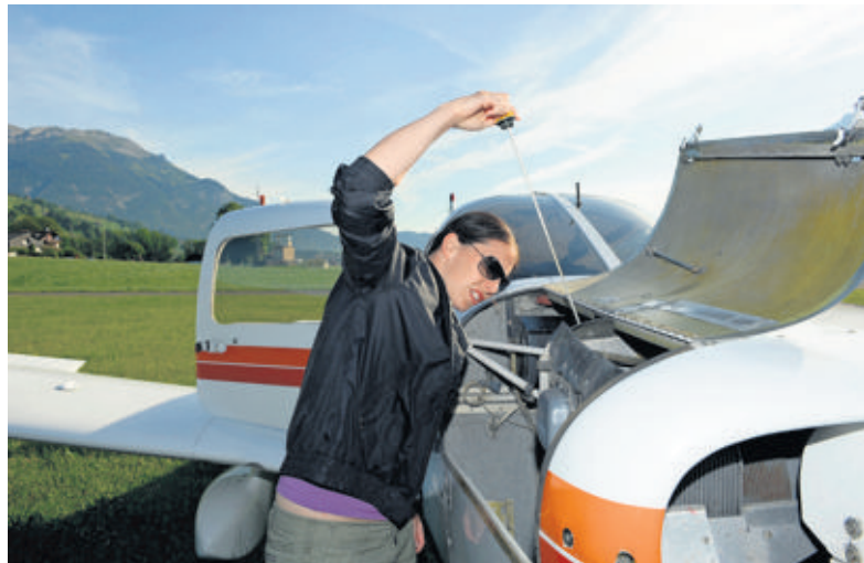
Contrôles Après avoir sorti le Piper quatre places de son hangar, elle effectue toutes les vérifications d'usage. Le niveau d'huile est peu distinct. Avec deux passagères de plus, y aura-t-il assez d'essence jusqu'à Zurich?
